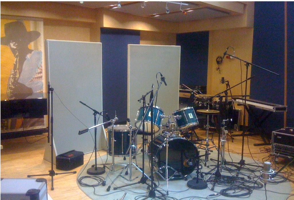
*Abb. 7: Provisorische Schlagzeugmikrofonierung*
