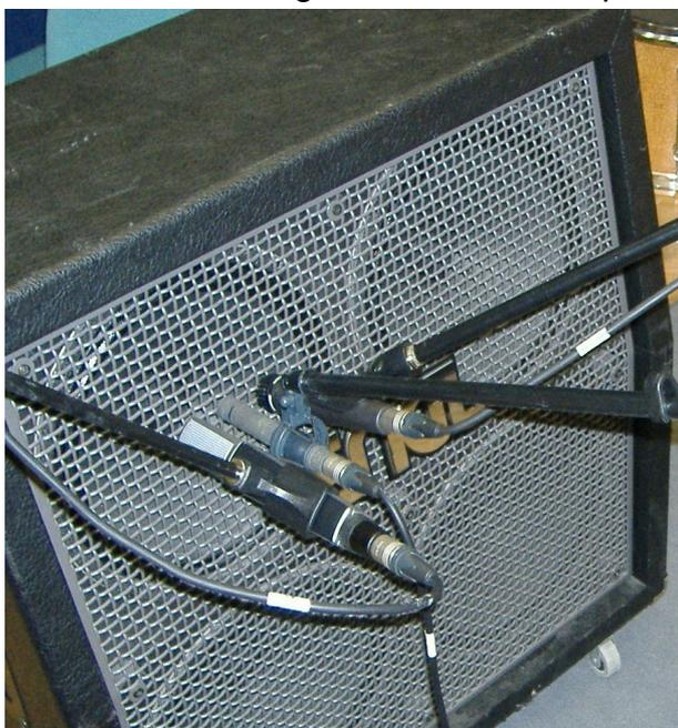
Abb. 12: Mikrofonierung beim Re-Ampen
