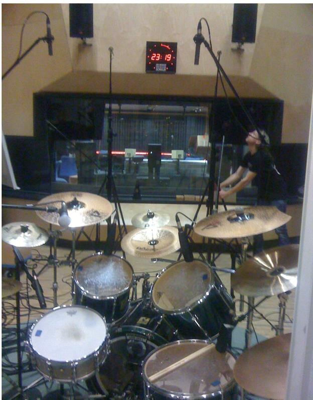
Abb. 9: Schlagzeug-Mikrofonierung
