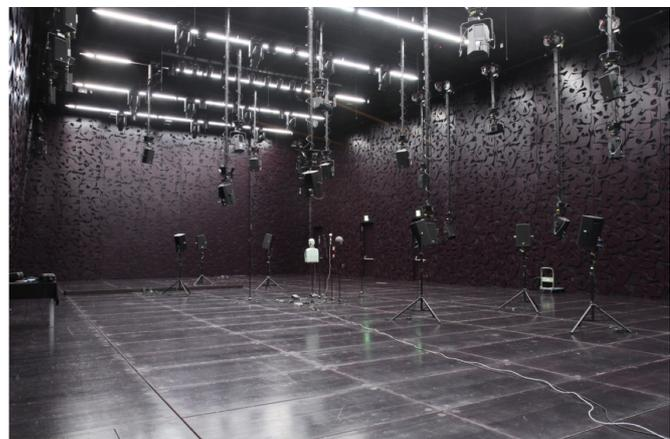
Abbildung 17: Motorisierte Lautsprecherkonfiguration mit Messaufbau
