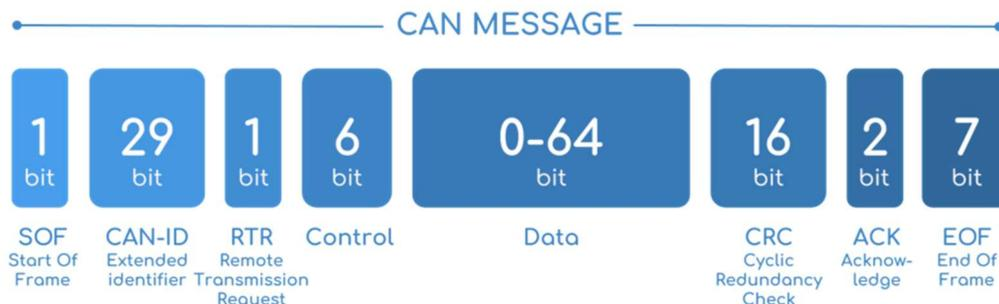
Abbildung 12 Unterteilung eines CAN-Frames<sup>24</sup>
