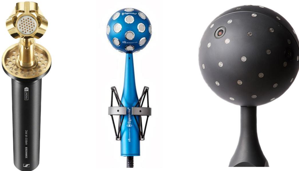
Abbildung 7: Links: Sennheiser Ambeo® VR-Mic mit vier Kapseln für FOA. | Mitte: MH Acoustics Eigenmike® mit 32 Kapseln für HOA bis vierter Ordnung. | Rechts: Visiconics Audio/Visual Camera mit 64 Kapseln für HOA bis zu siebter Ordnung
