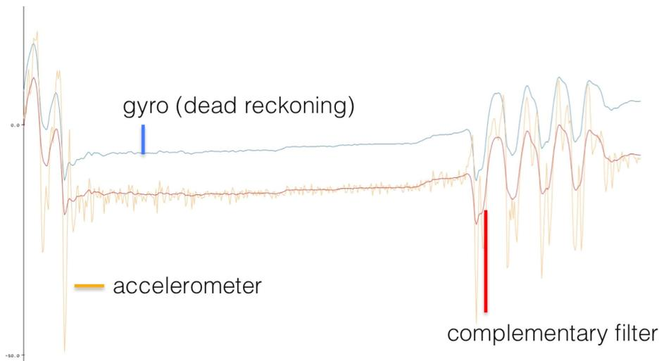
**Abbildung 4.8:** Plot von Roll-Winkeln (gemessen und angenähert). Quelle: Wetzstein (2017, S. 4).
