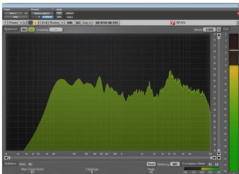
Hierdurch wird die Frequenzverteilung zu einem Zeitpunkt dargestellt. Die Einteilung der X-Achse erfolgt dabei kontinuierlich, in Terz- oder in Oktav-Bändern. Der Graph verändert sich deshalb kontinuierlich, sofern sich die Frequenzverteilung des Audiosignals verändert. Eine Aussage über den zeitlichen Verlauf eines Signals nur anhand
