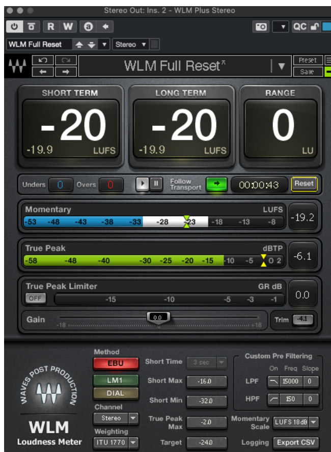
Abbildung 6: Loudness-Messung im WLM Plus Loudness Meter bei einer Atmo-Aufnahme (eigener Screenshot)
