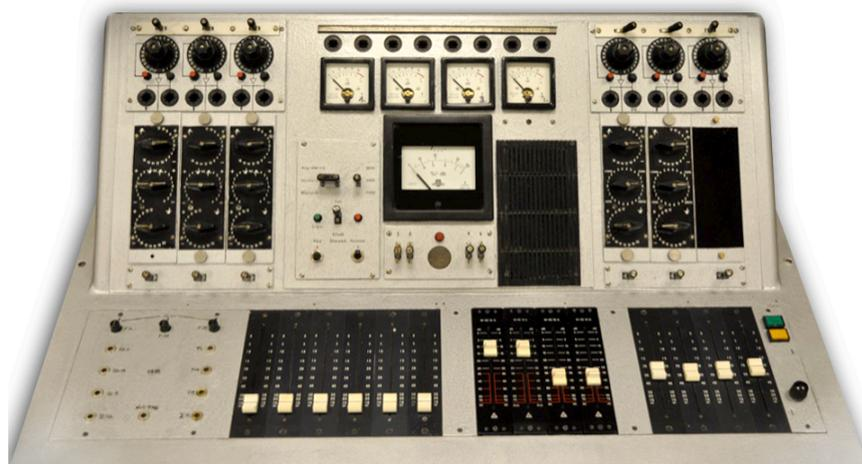
Abb. 34: Tonfilmkonsole KL RS 060 bestückt mit V72 Verstärkern
