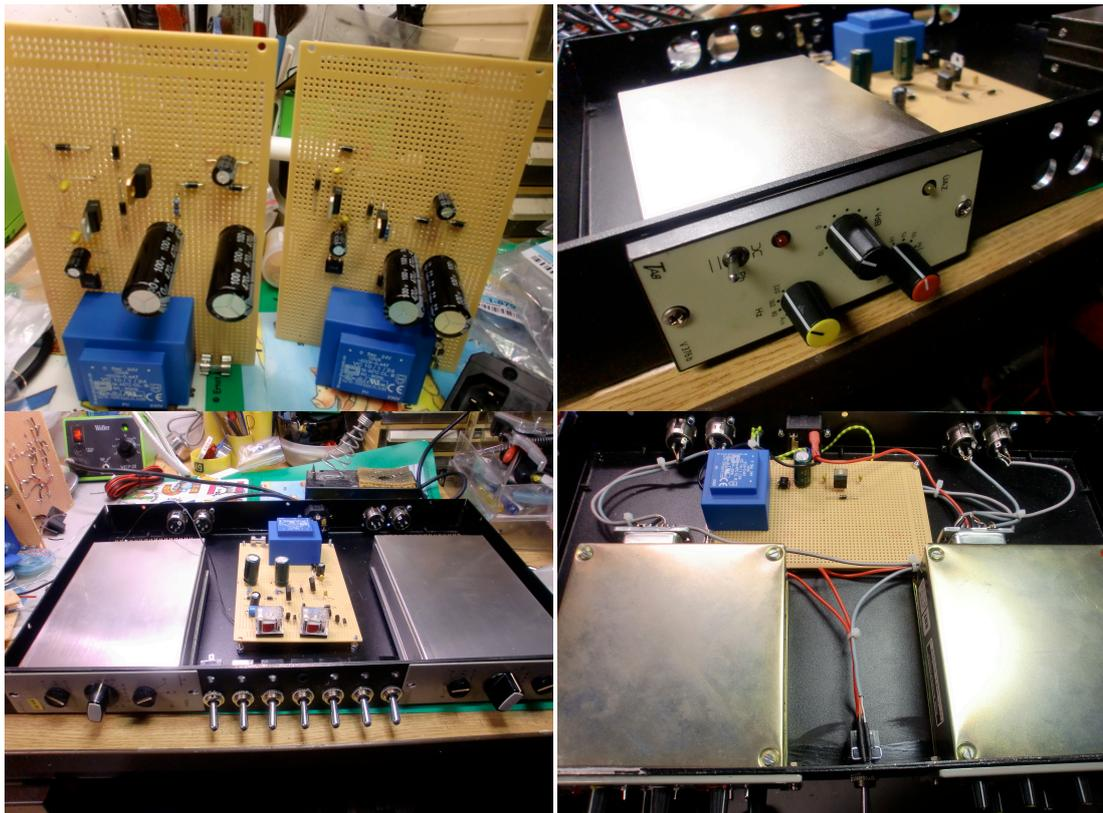
Abb. 50: Zwei vorbereitete Netzteilplatten (oben links), Einpassung des V376b Verstärkers (oben rechts), bestücktes V276a Gehäuse mit Netzteilplatte (unten links), fertig gestelltes MK5b Gehäuse (unten rechts).
