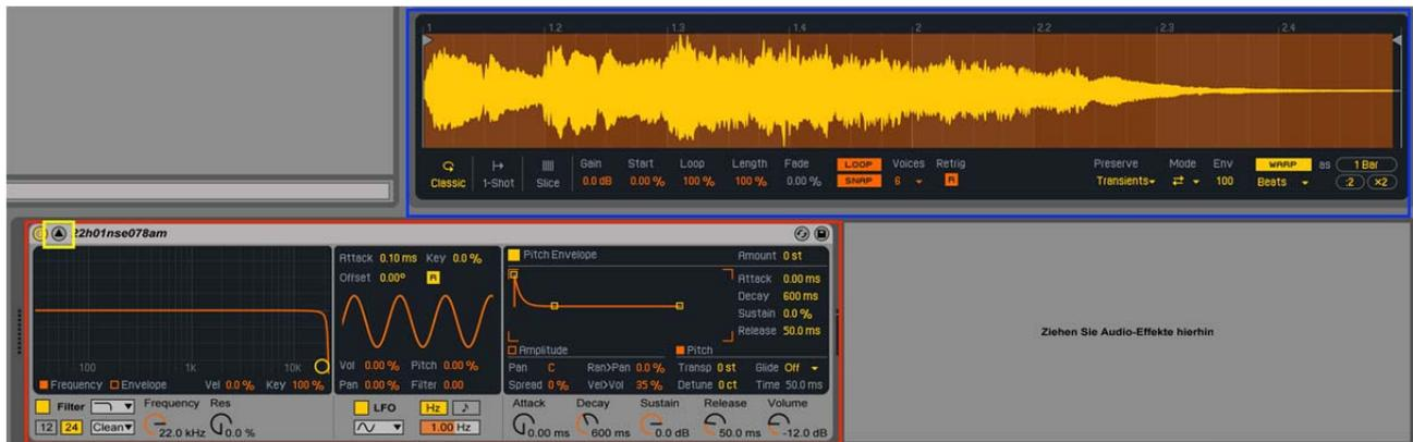
In rot befindet sich die Control-Sektion wo Filter, LFO und Pitch Envelope (Hüllkurve) abgebildet sind. In Blau dann das eigentliche Sample im Sampler und die Einstellungen für das Instrument (Loop, Modus, etc). In Gelb habe ich den Knopf gekennzeichnet der mir diese Ansicht erlaubt. Dies geht auch bei vielen anderen Sachen in Ableton und erlaubt einem einen besseren Überblick über alle Parameter und Dateien die man bearbeitet.
