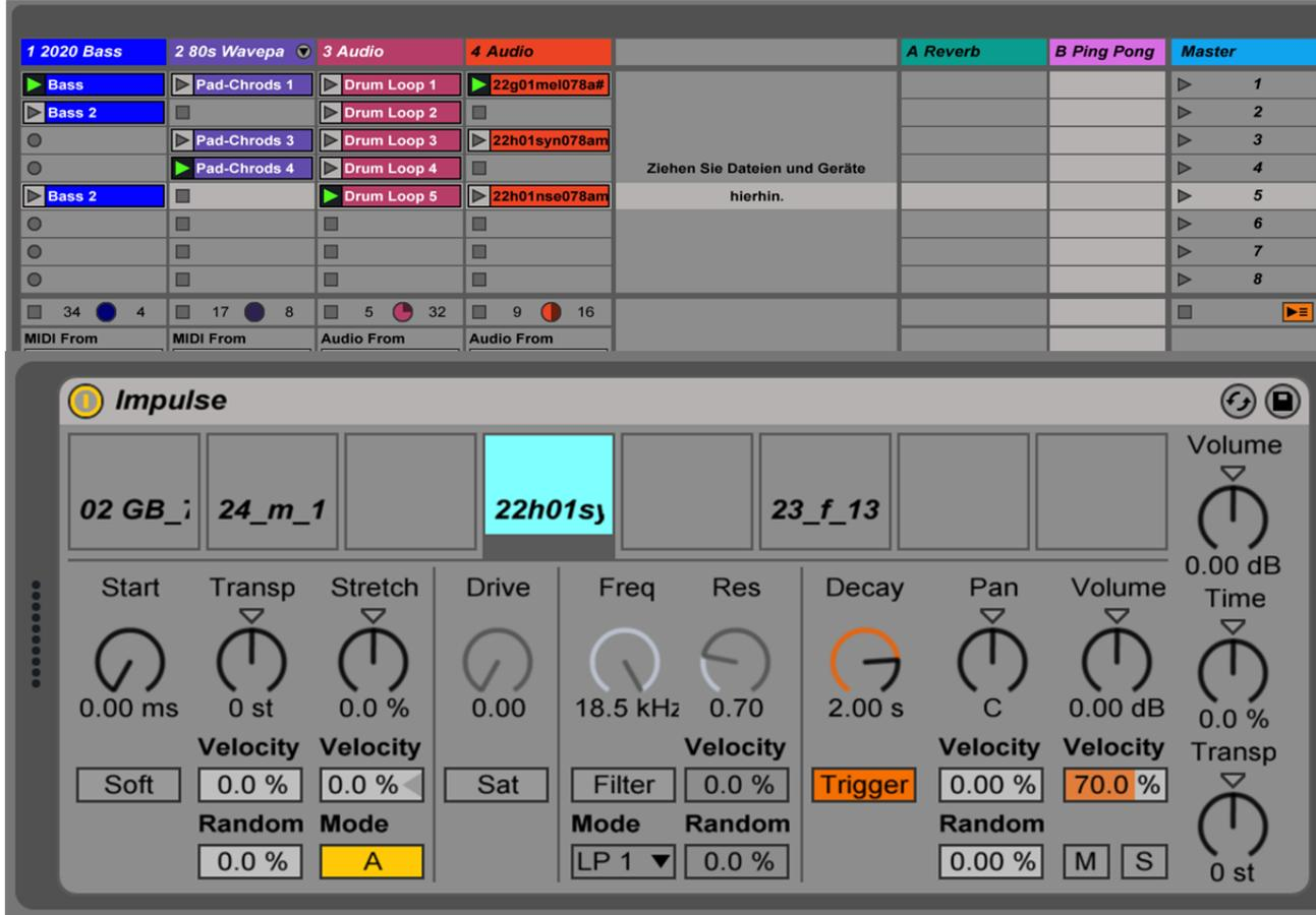
Impulse ist ein triggerbasiertes Sampleinstrument. Ähnlich wie bei einem MIDI-Controller der Pads hat zum Abspielen von Sounds, legt man Samples und Audio auf die Flächen von Impulse und spielt diese dann mit dem Keyboard ab. Dabei kann das Sample bearbeitet werden mit Transpose und Stretch. Egal wie lange die Audiodatei ist Impulse beschränkt sich für alle auf eine bestimmte Länge.
